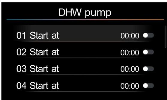
On the DHW page, select DHW pump and press the [  ] to enter the DHW pump page.
